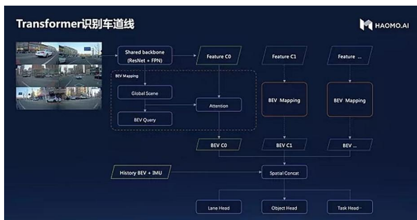
毫末智行用于识别车道线的 BEV 时空融合感知网络
