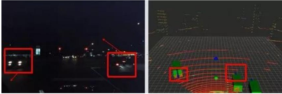
结合激光雷达，夜晚能准确给出车辆的 heading 信息
